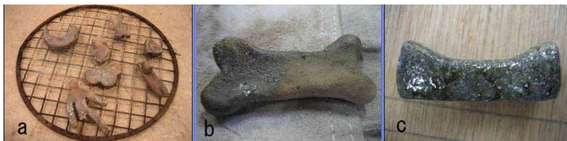
図1．焼き締め効果の比較 (a,b.灰が溶けていない c.灰がしっかり溶け光沢がある)
