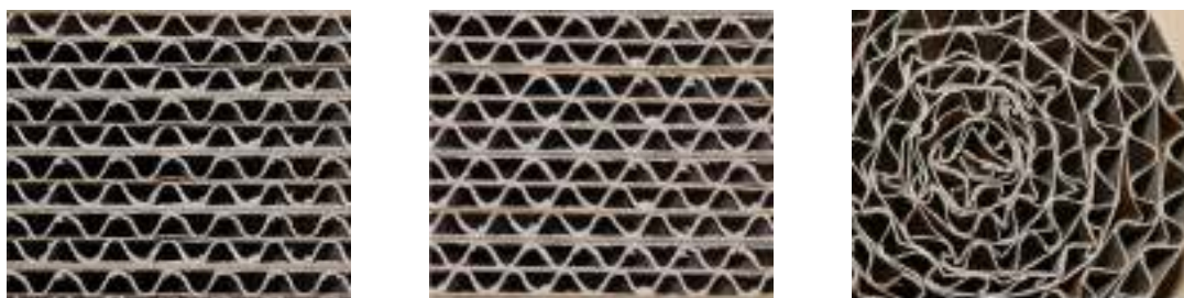
図1. ダンボールの構造と面模様
